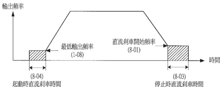
圖 4-20：直流煞車機能
