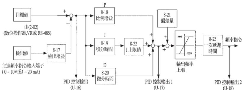
圖 4-24：PID 控制架構圖 (當(8-16)=1, PID 控制有效時)
