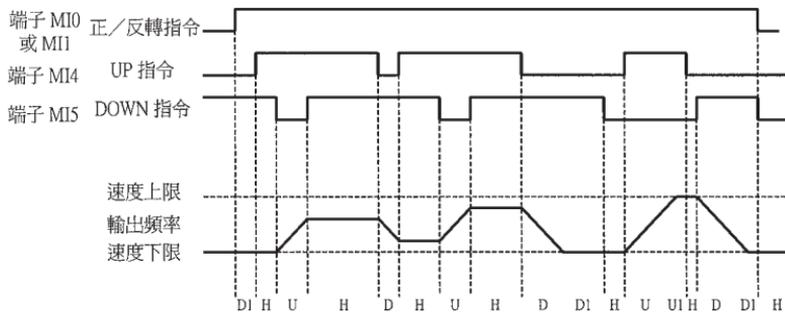
U = UP (加速) 狀態                      U1 = 在 UP 狀態下，被速度上限限制住
