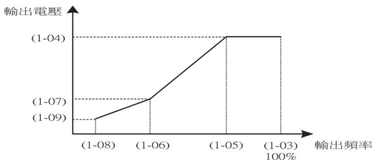
圖 4-1：電壓 / 頻率 (V / F) 曲線設定
