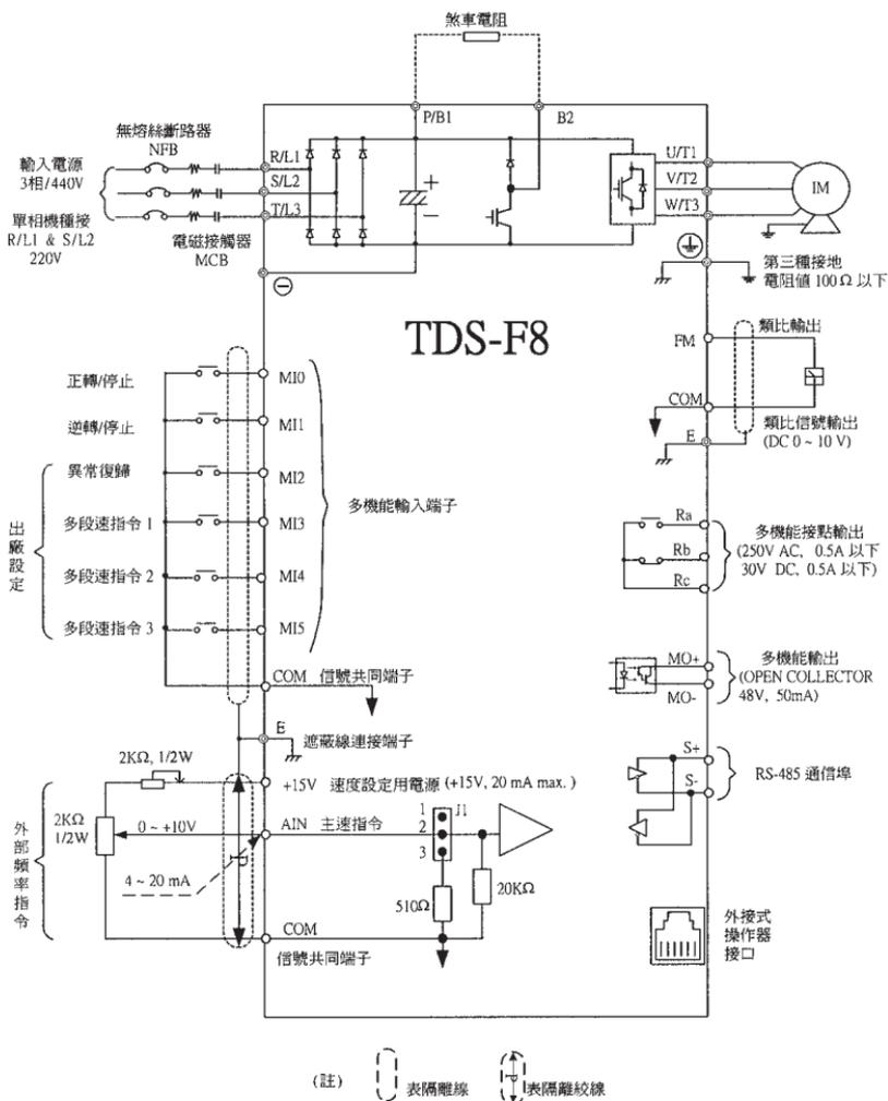
圖 2-1 變頻器標準配線圖 (◎表示主回路端子，○表示控制回路端子)
